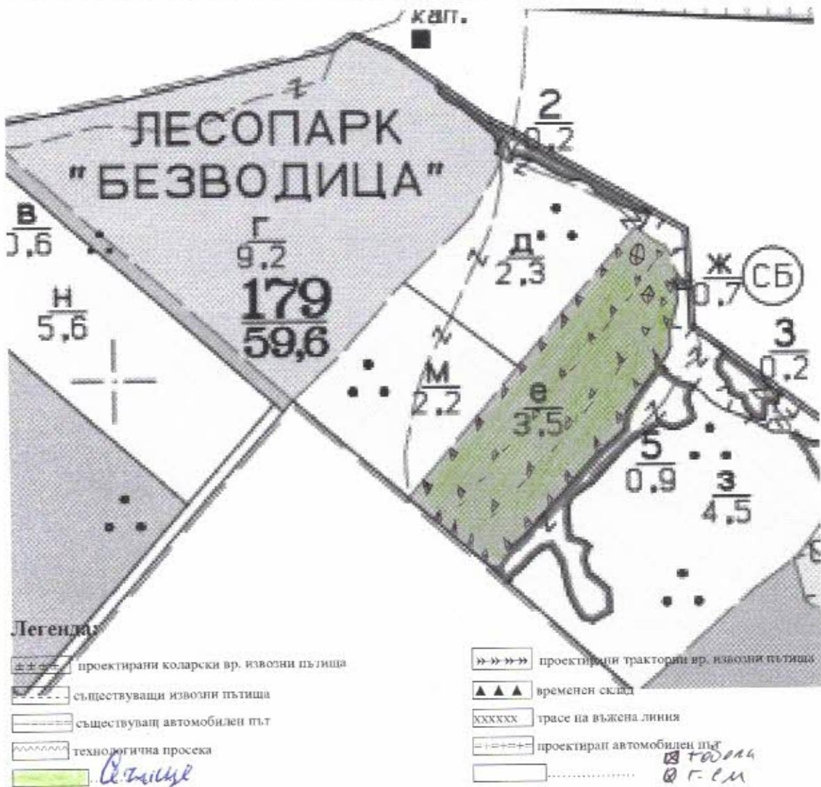
На схемата задължително се нанасят контурите на насаждението/имота, съществуващите и проектирани временни горски пътища, технологичните просеки, просеките за възможни линии, извозни пътища, временни складове както и връзката им със съществуващата автомобилна пътна мрежа.
